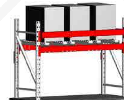
Casier équipé de niveaux à rouleaux pour le stockage de moules.
